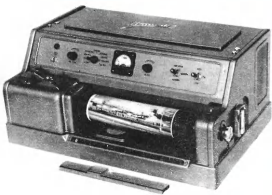
Фототелеграфный аппарат ФТА-М2
